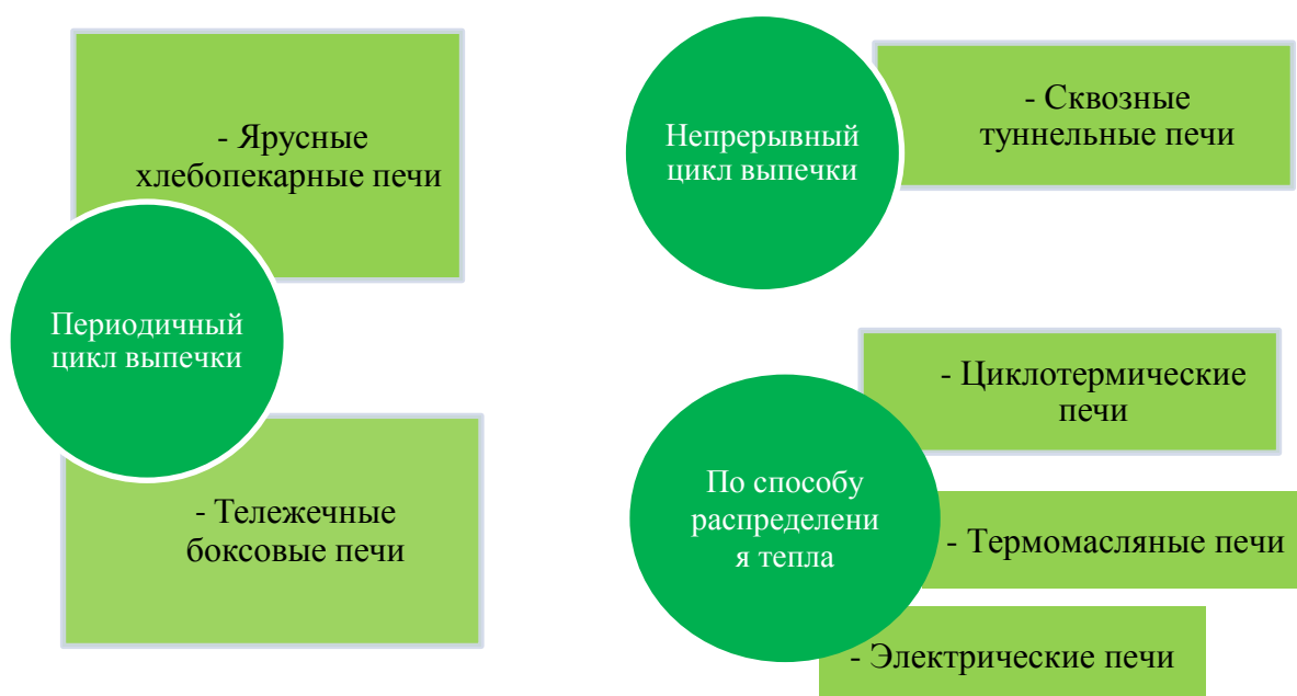
Рисунок 4. Классификация печей в соответствии с технологическим исполнением и конструкторскими особенностями
